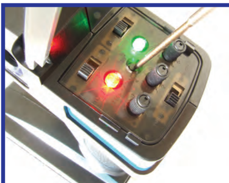
Quand vous avez allumé votre radio vous pouvez relâcher le bouton "blind", la LED verte va se mettre à clignoter pour vous indiquer que l'opération de couplage est en cours.
